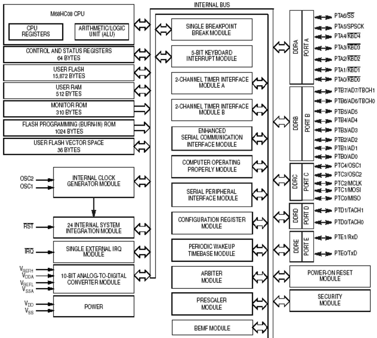
Figure 3. MC68HC908EY16 MCU Block Diagram
